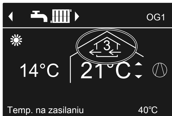
Rys. 20 Przykład wentylacji w programie roboczym „Aut. układ wentylacji”, status roboczy „Normal”
