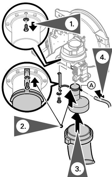
1. Schraube M5 x 16 und Scheibe 5,3 vom Gehäuse lösen.
