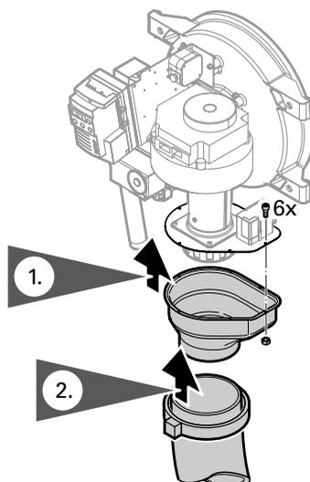
1. Zuluftkasten mit sechs Zylinderschrauben M4 x 10 und Sechskantmuttern am Flansch der Drehschieberklappe befestigen.
