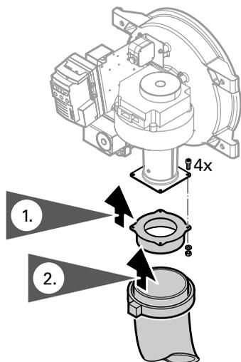
1. Zuluftadapter mit vier Schrauben M6 x 16, Scheiben 6,4 und Sechskantmuttern am Venturi-System befestigen.
