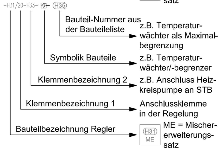
**Beispiel der Anschlussbeschriftung für Sensoren und Aktoren an Viessmann Regelungen**
