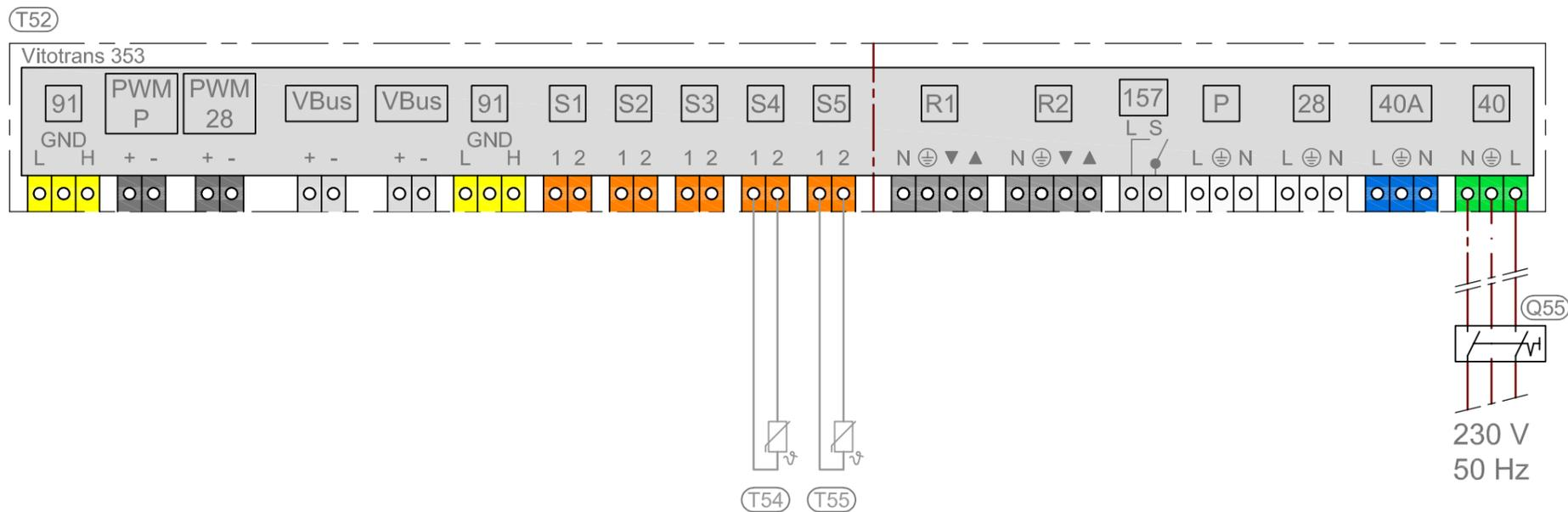
**Hinweis:** Der E-Plan zeigt nur Komponenten, die noch bauseits / vor Ort verdrahtet werden müssen. Komponenten, die bereits im Gerät verdrahtet sind, werden nicht oder, sofern andere Komponenten parallel verdrahtet werden müssen, grau dargestellt. Zum Anschluss der internen Komponenten bitte die entsprechenden technischen Unterlagen beachten.
