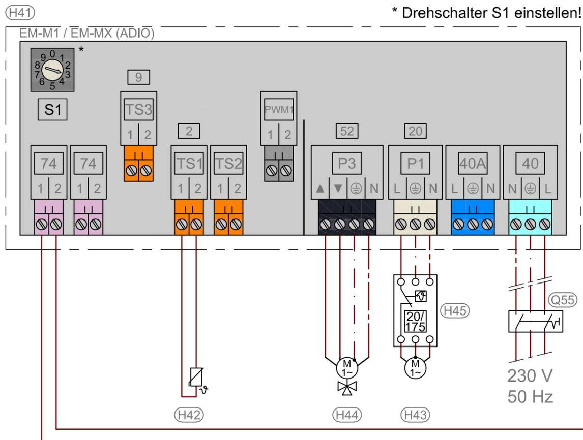
**Hinweis:** Der E-Plan zeigt nur Komponenten, die noch bauseits / vor Ort verdrahtet werden müssen. Komponenten, die bereits im Gerät verdrahtet sind, werden nicht oder, sofern andere Komponenten parallel verdrahtet werden müssen, grau dargestellt. Zum Anschluss der internen Komponenten bitte die entsprechenden technischen Unterlagen beachten.
