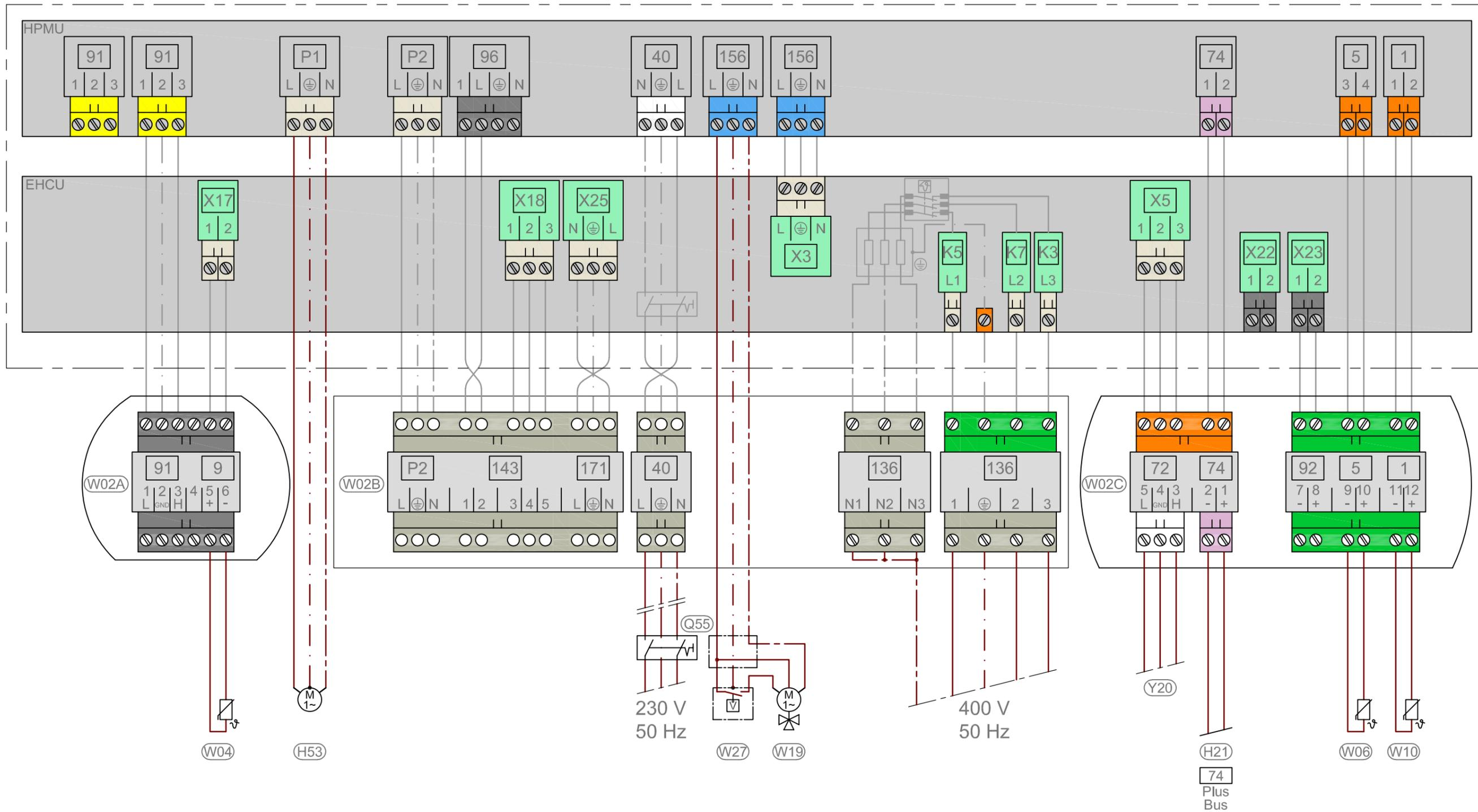
**Hinweis:** Der E-Plan zeigt nur Komponenten, die noch bauseits / vor Ort verdrahtet werden müssen. Komponenten, die bereits im Gerät verdrahtet sind, werden nicht oder, sofern andere Komponenten parallel verdrahtet werden müssen, grau dargestellt. Zum Anschluss der internen Komponenten bitte die entsprechenden technischen Unterlagen beachten.
