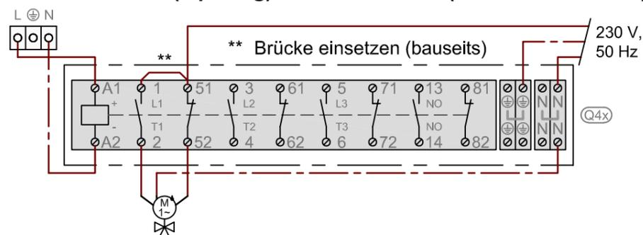
**Weitere Anschlussmöglichkeiten Umschaltventile**
